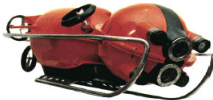
PLUTO è il veicolo subacqueo filoguidato dotato di strumentazione di video-ripresa utilizzato nella ricerca.
