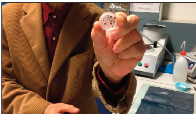
Fig. 6. Come si presenta un 'inglobato' in resina epossidica al cui interno sono stati annessi 25 micro frammenti prelevati da altrettanti campioni di ossidiana di Padre Carmelo. L'inglobato viene poi sottoposto alla 'electron microprobe' che può così effettuare analisi multiple degli elementi chimici presenti in ogni micro frammento.
