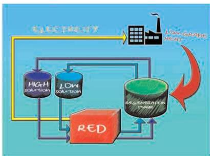
Fig.4. Schema di funzionamento del motore termico ad elettrodialisi inversa (Reverse Electrodialysis Heat Engine, REDHE).
