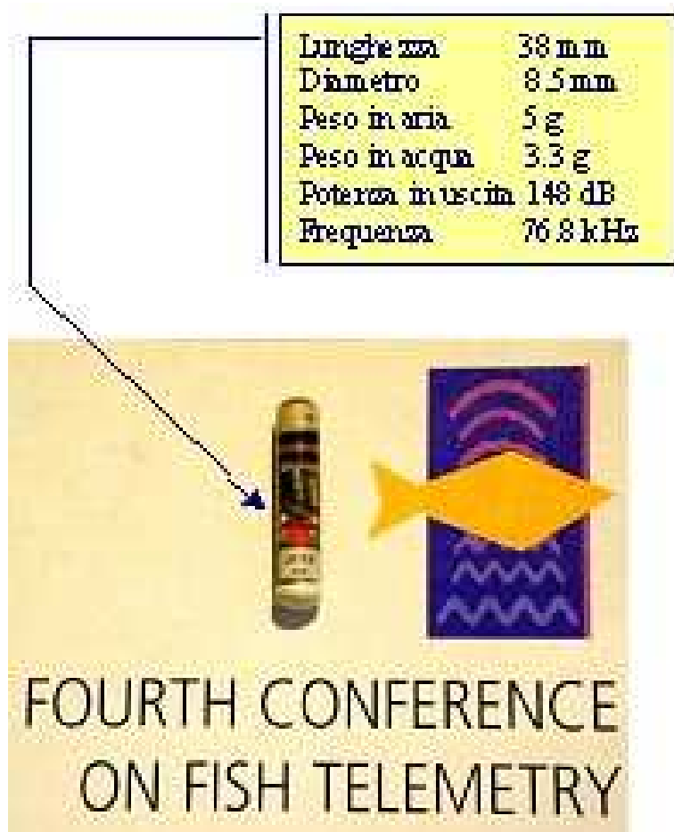
Trasmettitore miniaturizzato impiantato chirurgicamente nella cavità addominale degli individui giovanili di cernia (nel riquadro sono indicate le caratteristiche tecniche). (tratto dal manifesto del 4° Convegno di Telemetria)
