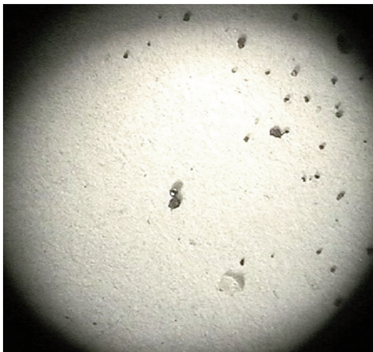
Aspetto al microscopio ottico di un gruppo di particelle raccolte col magnete nel pozzetto di Vicolo III Chiesa. Fra i tanti frammenti ferrosi di forma irregolare, spicca, al centro, una sferula.
